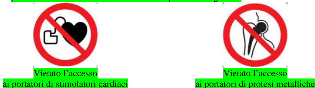
Figura 4.3: segnaletica di divieto prevista dalla UNI EN ISO 7010:2012 per lavoratori particolarmente sensibili al rischio da campi elettromagnetici.
